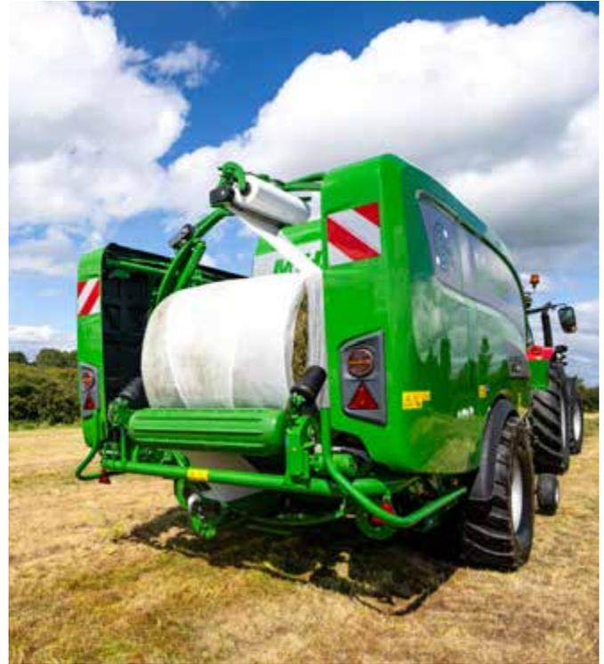
03 Au fur et à mesure que la balle se forme à l'intérieur de la chambre, le système de densité hydraulique prend le relai par rapport aux ressorts. Deux vérins hydrauliques contrôlent la tension sur la ou les courroie(s) de la chambre.
