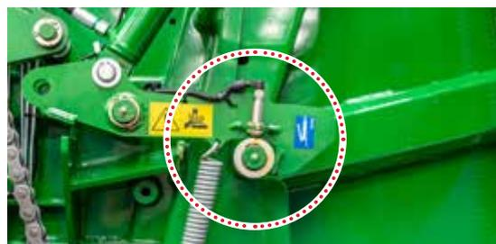
Système de verrouillage de la porte mécanique
