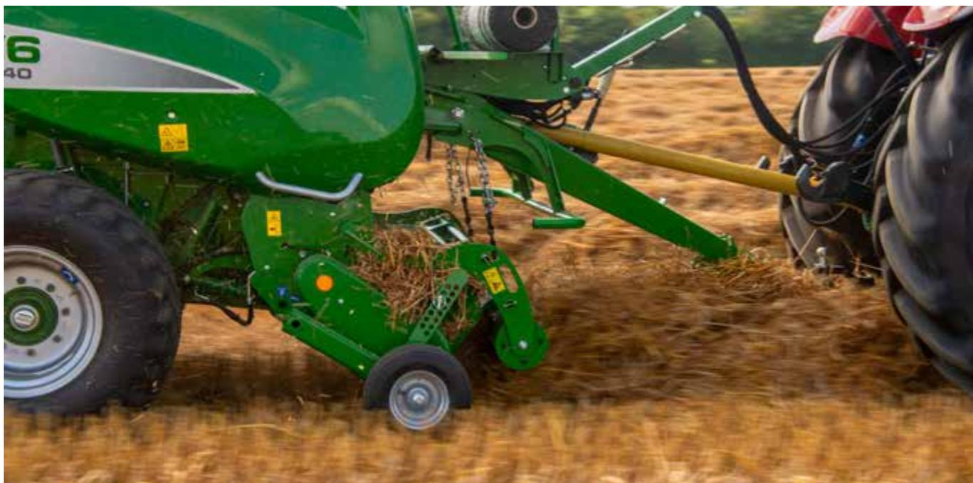
Le nouveau fond d'alimentation conique entre le pick-up et le rotor est monté sur suspension. Il s'ajuste automatiquement suivant le volume de fourrage. Ceci permet d'absorber plus facilement les inégalités d'andains et ainsi améliorer le débit de chantier. Les vis sans fin de recentrage du fourrage ont été redessinées et leur position avancée.
