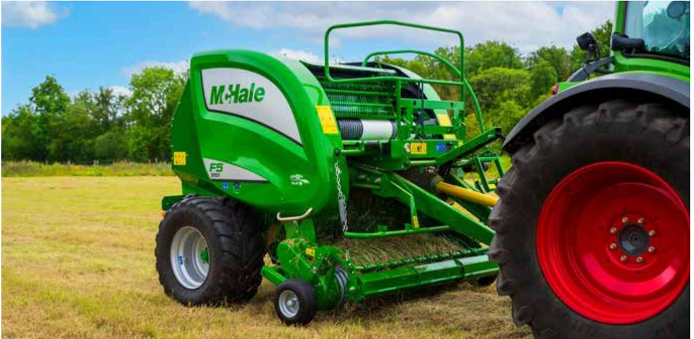
Der neue konisch zulaufende Zuführkanal verbessert den Erntegutfluss von der Pick-up zum Rotor und in die Ballenkammer, womit der Durchsatz maximiert wird. McHale hat ebenfalls die seitlichen Förderschnecken nach vorne versetzt und ihre Enden zum Rotor hin abgewinkelt, um den Gutfluss zu verbessern.
